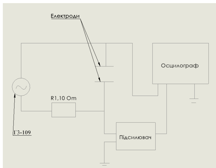
Рис. 1. Схема проведення вимірів вимірювання імпедансу (зсуву фаз) шкіри
